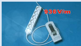
Foto 1: Radiación fuera del cable.
